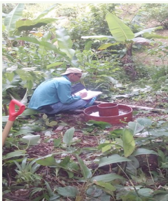
Figura 2. Determinar de la velocidad de infiltración del suelo en la localidad de Valle Riscó. Almirante, provincia de Bocas del Toro, República de Panamá, 2016-2017.
